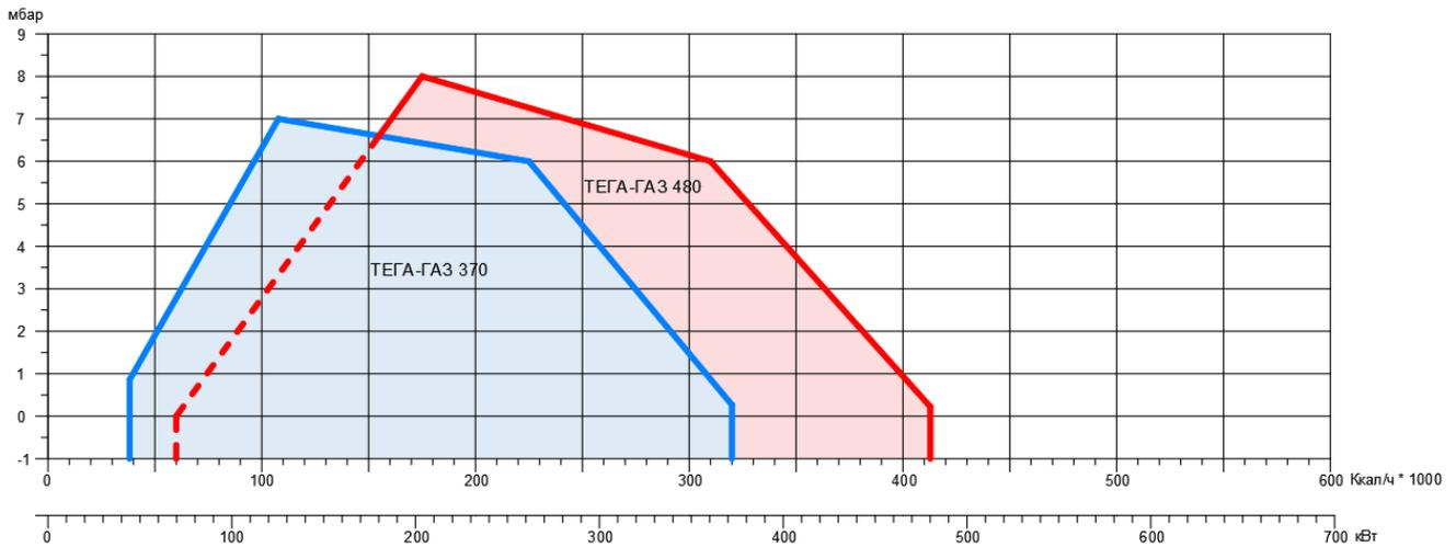
График рабочего поля горелок ТЕГА-ГАЗ 370.4 – 480.4
