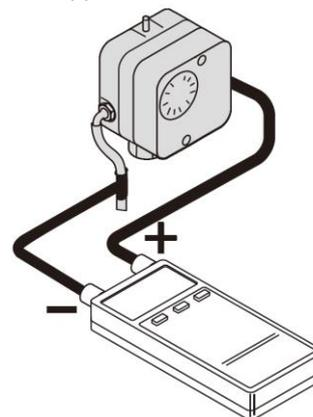
Значение уставки давления воздуха рассчитывается умножением значения избыточного давления на соединении в корпусе горелки на коэффициент 0,8. Откройте крышку регулятора и медленно вращайте ручку, чтобы задать нужную уставку. Если горелка выключится, поверните ручку регулировки в направлении «←» (против часовой стрелки) на 20 %, а затем снова запалите горелку и убедитесь, что она работает.
