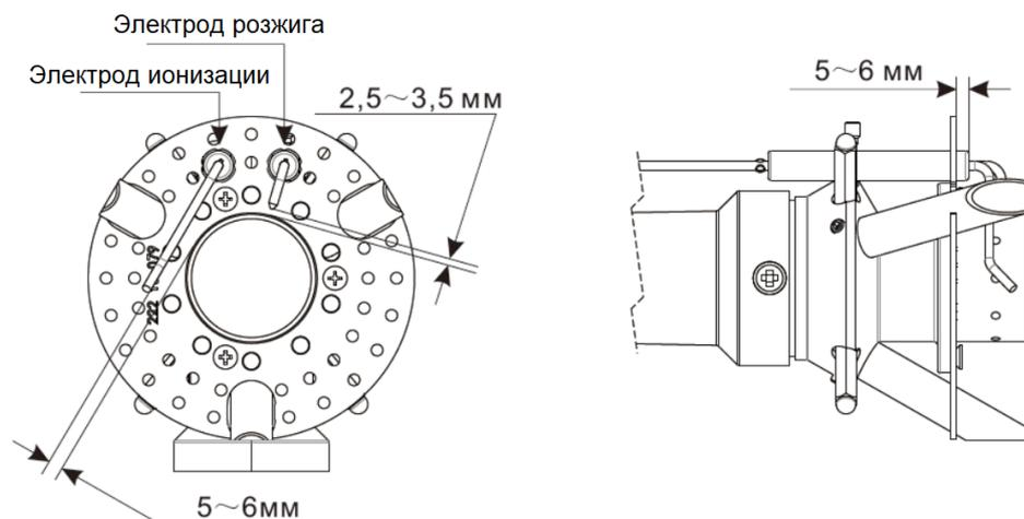
Для горелок мощностью **свыше 480 кВт** расположение электродов розжига и обнаружения пламени (ионизации) должно соответствовать следующей схеме:
