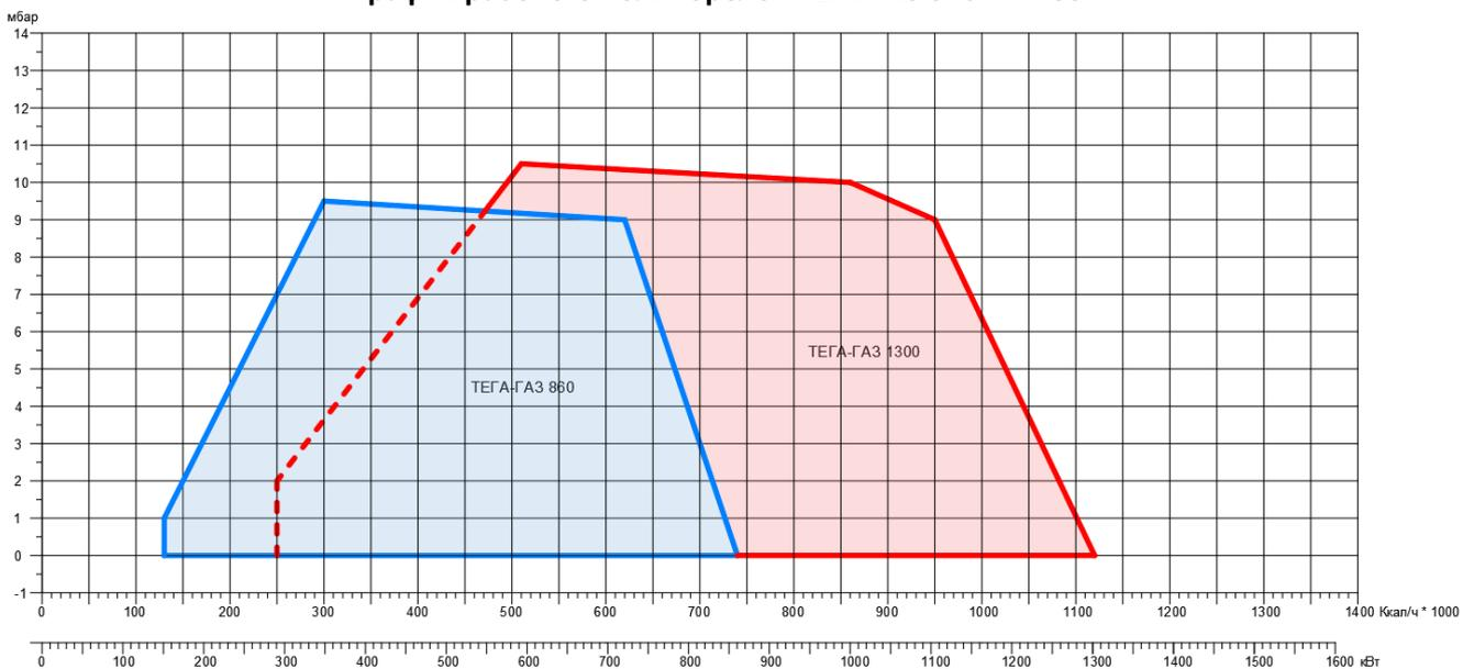
График рабочего поля горелок ТЕГА-ГАЗ 860.4 – 1300.4
