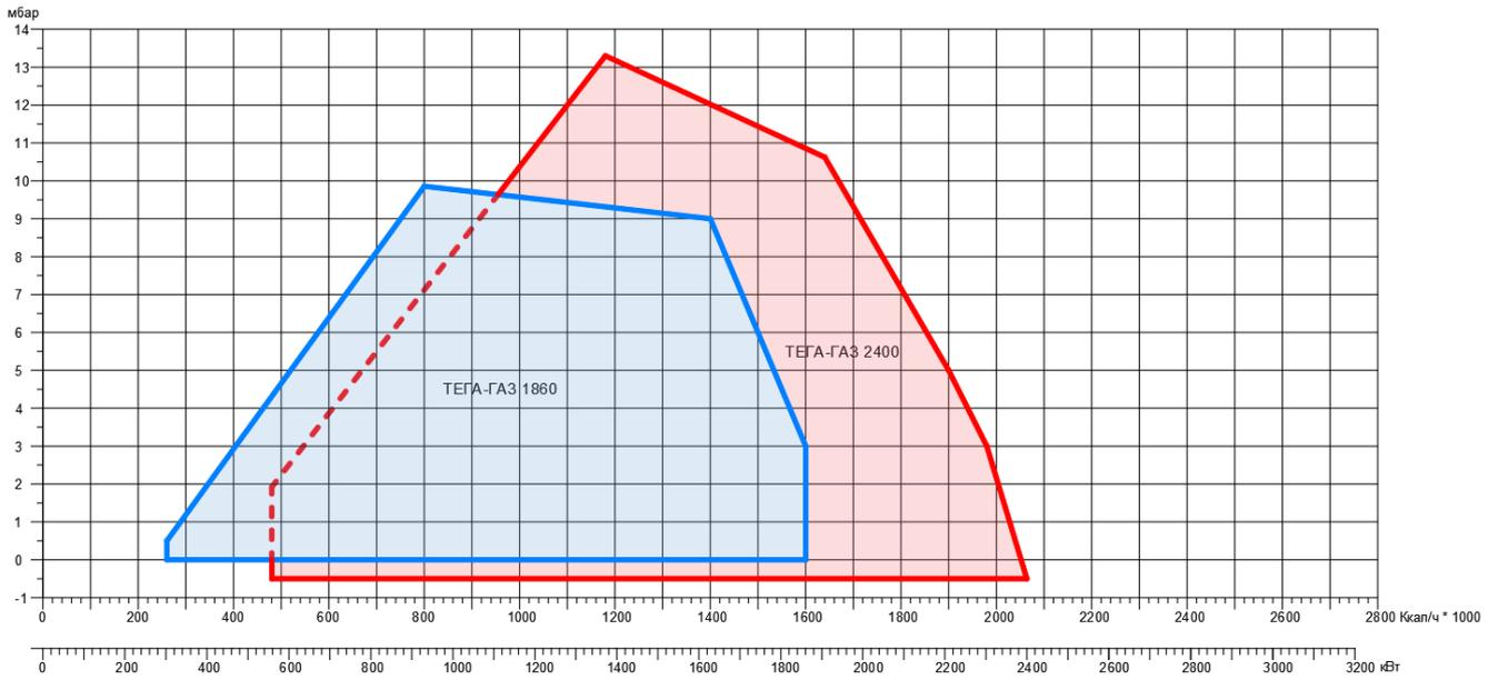
**График рабочего поля горелок ТЕГА-ГАЗ 1860.4 – 2400.4**
