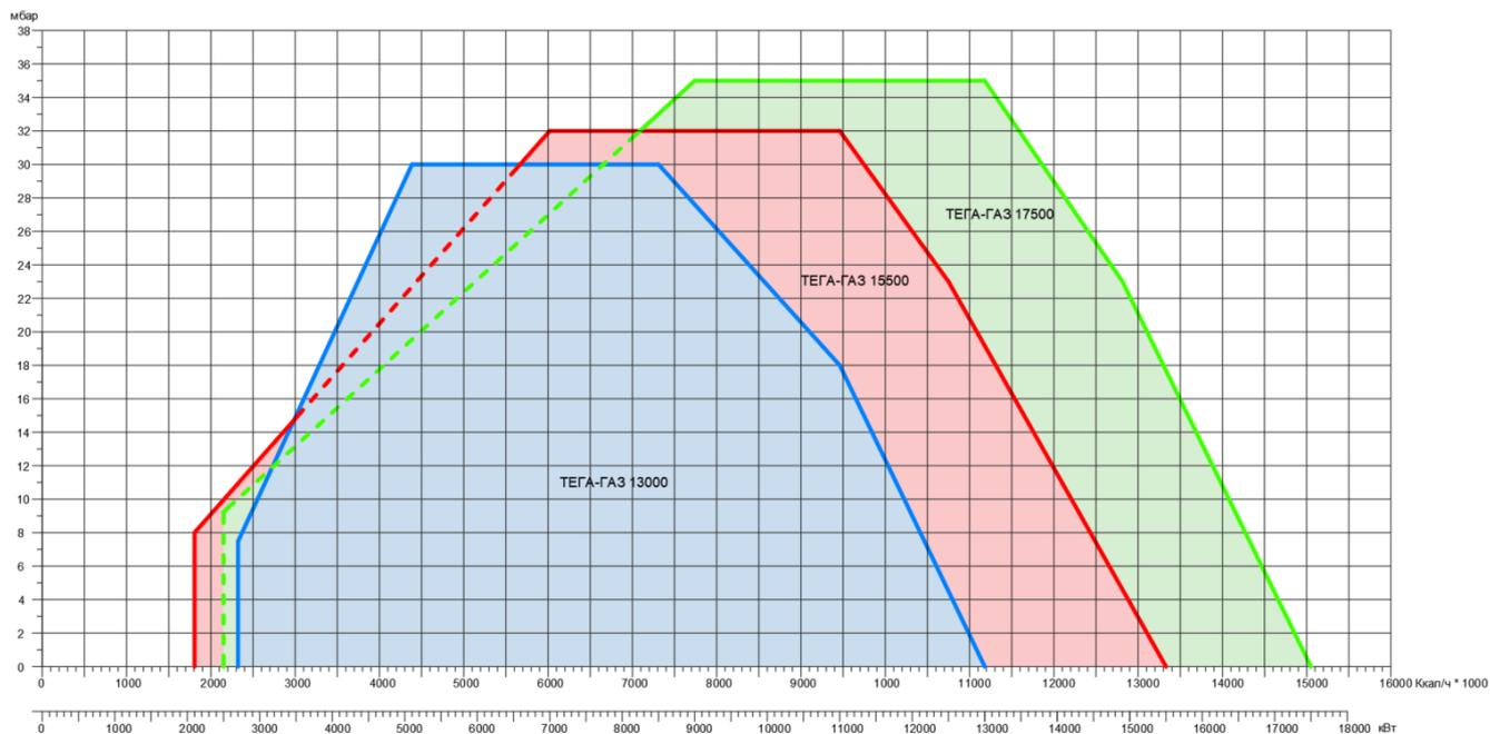
**График рабочего поля горелок ТЕГА-ГАЗ 1300 – 17500.4**
