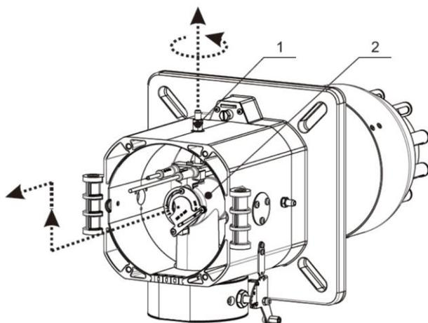
Для проведения работ по демонтажу форсунки необходимо выкрутить шесть болтов (поз. 1) (см. направление вращения на схеме), а затем извлечь форсунку. Установку необходимо выполнять в обратной последовательности.
