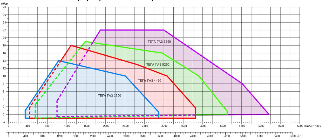
**График рабочего поля горелок ТЕГА-ГАЗ 3600.4 – 6250.4**
