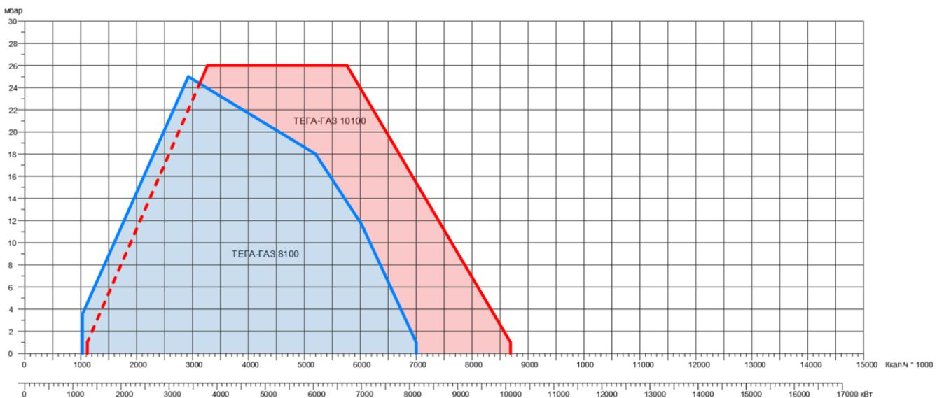
**График рабочего поля горелок ТЕГА-ГАЗ 8100.4 – 10100.4**
