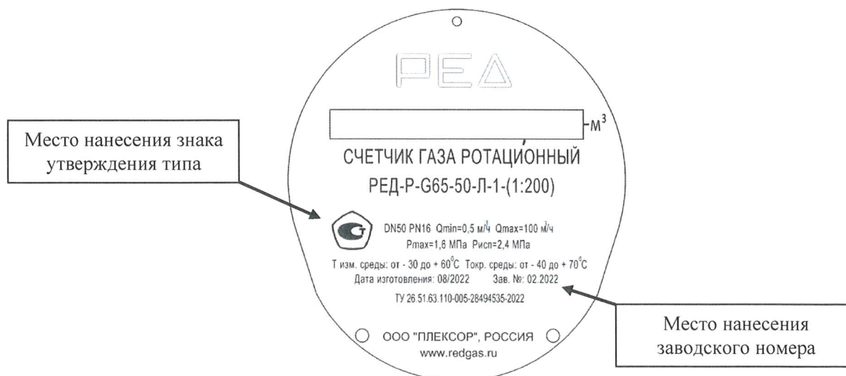
Рисунок 2 – Место нанесения заводского номера, знака утверждения типа
